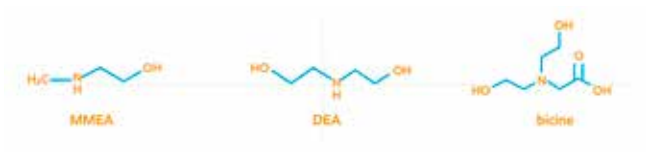
Figura 2. Impurezas típicas de la MDEA.
